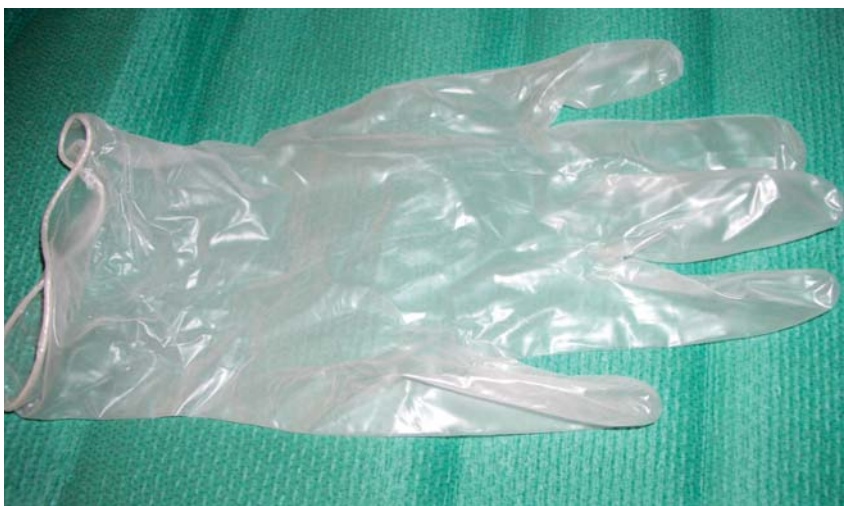
Fig. 2. Guante de examen de polímero de vinilo, empolvado no estéril y ambidiestro. Sin látex. 100% polímero sintético.
